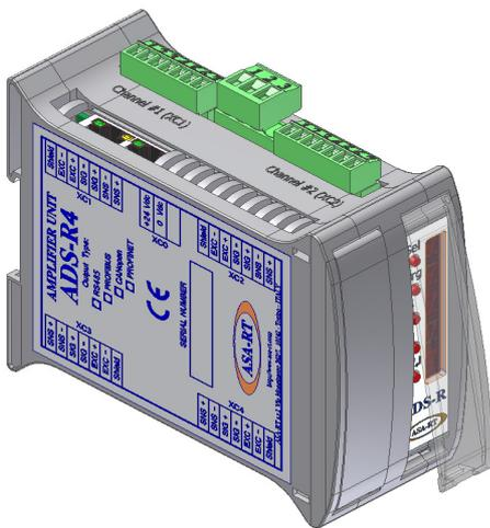
Der ADS-R4 ist ein Multi-Kanal-Messverstärker für extensiometrische Brücken. Er erlaubt die gleichzeitige Zusammenführung von bis zu vier einzelnen Messsensoren und ist mit Feldbus Profinet I/O, Profibus DP oder CANopen DS404 - Schnittstelle verfügbar.
