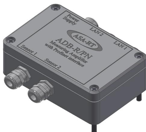
L ' ADB-R è un amplificatore di misura digitale per ponte estensimetrico, dotato di un circuito di acquisizione a 24 bit con guadagno programmabile, ed interfaccia su bus di campo (Profinet I/O) verso un supervisore di macchina.
